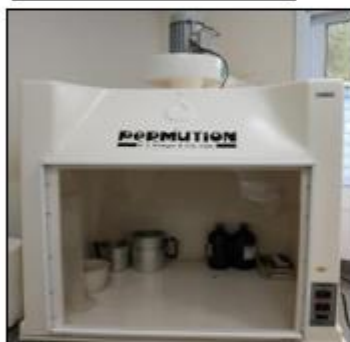
CAPELA DE EXAUSTÃO
